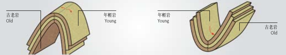
圖7-6a. 背斜及向斜。 Figure 7-6a. Anticline and syncline.
