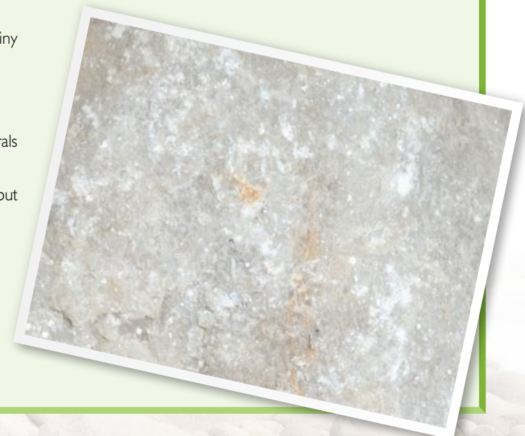
圖1-19. 大理岩，含有結晶的方解石礦物。 Figure 1-19. Marble, containing crystalline calcite minerals.
