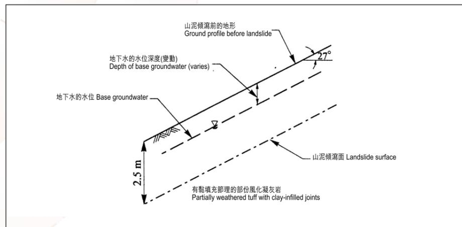
圖B-7. 用作斜坡穩定性分析的事發地點代表剖面圖 - 下部平面滑動。
