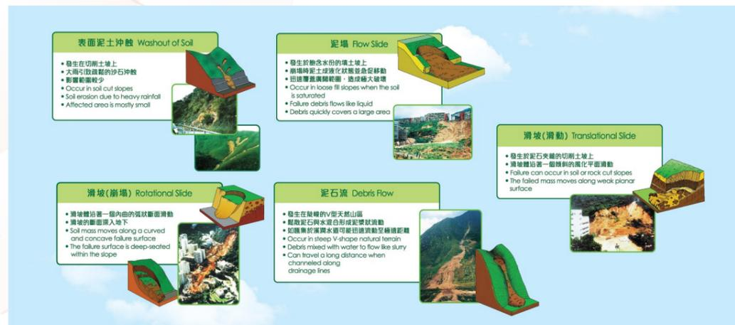
圖32. 常見的山泥傾瀉模式(土坡)。
