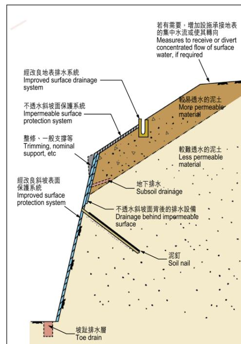
圖38. 防止山泥傾瀉的一些常用工程方法。
