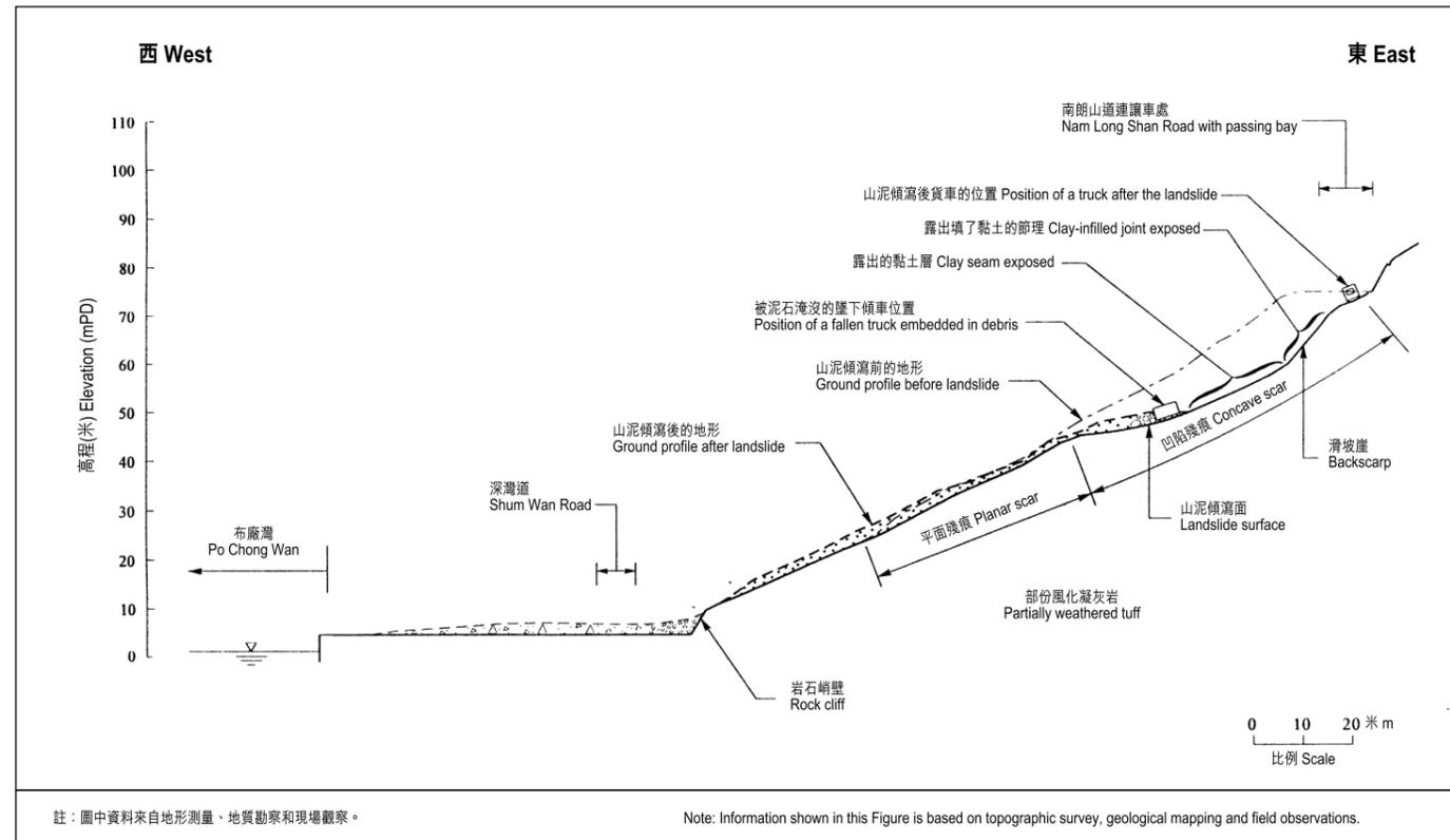
圖B-2. 崩塌地點剖面A-A。
