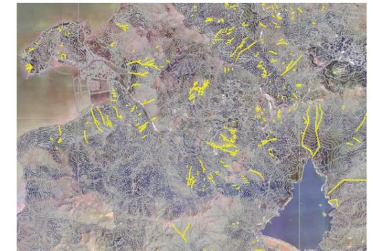
圖33. 2008年6月7日的暴雨導致在大嶼山西部超過400宗天然山坡倒塌(黃色線段)。
