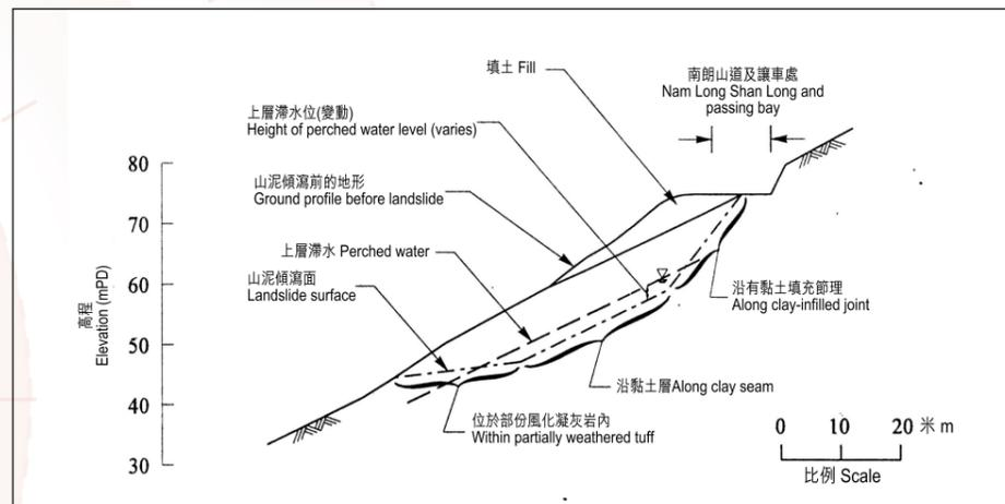
圖B-6. 用作斜坡穩定性分析的事發地點代表性剖面圖 - 上部匙形滑動。
