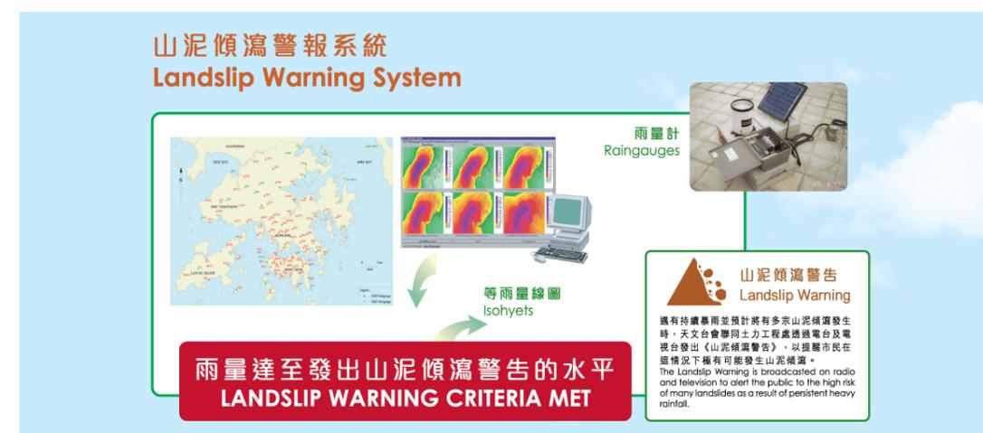
圖39. 山泥傾瀉警報系統。
